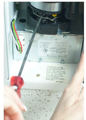
"DOWN" Limit (white) "AB" Grenze (weiß) Vis de réglage de limite inférieure (blanche)
