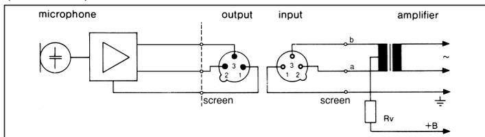
Collegamento con trasformatore d'ingresso **senza** presa mediana (senza terra).
