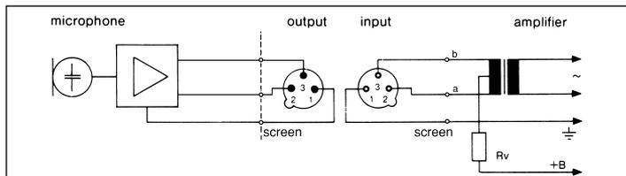
Circuito con transformador de entrada **sin** derivación central (aislado de tierra):
