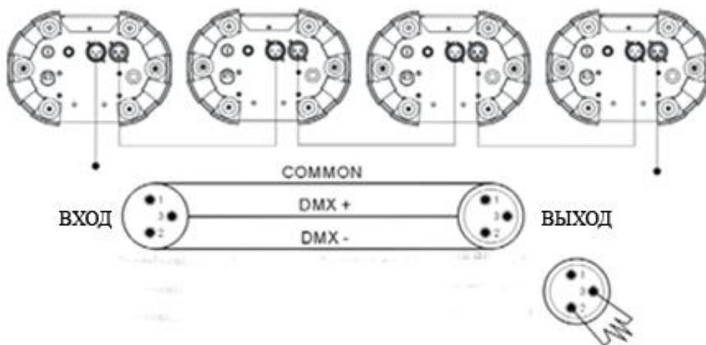
1. При помощи XLR кабелей последовательно соедините приборы (от выхода предыдущего к входу последующего устройства). Кабель не может быть разветвлен, не используются кабели типа Y. Не подходящие и поврежденные кабели, спаянные соединения и ржавые разъемы могут исказить сигнал и привести к выключению системы.
