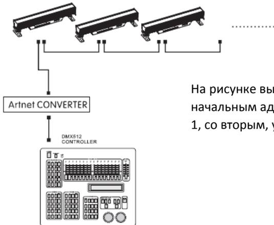
На рисунке выше показана простая схема DMX512 с начальным адресом первого устройства, установленным на 1, со вторым, установленным на (Nx1) +1 и так далее ...
