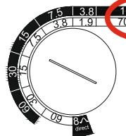
При использовании сабвуфера в 100V или 70V режиме необходимо установить селектор в положение соответствующее одной из 5/6 доступных мощностей. Категорически запрещается при подключении сабвуфера к 100V/70V линии переводить селектор в крайнее левое положение - 8ohm. Это может вывести из строя усилитель.
