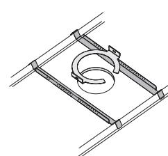
**5-** Führen Sie die C-Ring-Halterung durch das Loch. Schieben Sie den Ausschnitt zuerst in das Loch und drehen Sie dann die Halterung, sodass sie durch das Loch geschoben werden kann. Die Drähte müssen durch den Ring hindurch geführt werden.
