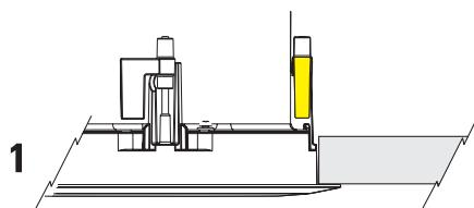
Después de que el gabinete esté instalado en la abertura de montaje, apriete el tornillo de cada abrazadera usando un destornillador Phillips N.º 2; vea 2 a la derecha.
