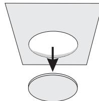
**2-** Schneiden Sie das Montageloch aus. Verwenden Sie dazu ein scharfes Werkzeug, um die Montagefläche nicht zu stark zu belasten und evtl. Sprünge zu verhindern.
