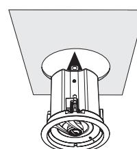
**12-** Au besoin, ajuster le câblage au point d'entrée et serrer la ou les vis sur le connecteur du câble blindé non métallique. Ceci permet d'éviter que les connexions/connecteurs se desserrent si les fils sont trop tendus.
