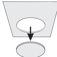
**2-** 挖出安装孔。使用尖利的工具以免压迫安装表面或使安装表面破碎。
