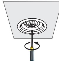
**14-** Insérer le boîtier dans la découpe du plafond, en s'assurant que les supports utilisés restent correctement positionnés. Serrer les vis de montage du haut-parleur.
