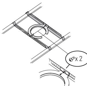
**8-** 临时支撑扩音器音箱，这样，就有足够的空隙使电线穿过扩音器音箱的顶部进行布线和收尾。
