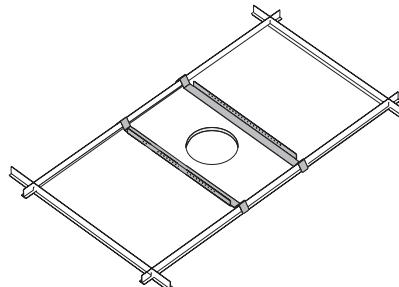
**6-** Coloque los soportes y asegure el soporte de anillo en C en cada uno de los soportes usando los tornillos que se proporcionan. Si la instalación se va a hacer en un cielo raso no suspendido, no haga este paso.
