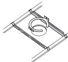
**6-** 放置支架，用提供的螺丝刀将 C 型环支架紧固在每个支架上。如果是非吊顶安装，跳过该步骤。
