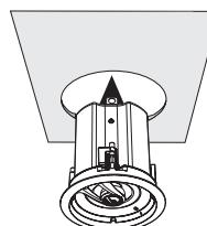
**10-** Quite aproximadamente 5 mm (0.2") del aislamiento de los extremos del cable e introduzca cada cable en su posición correcta en el conectador. Apriete totalmente los tornillos de retención del cable.
