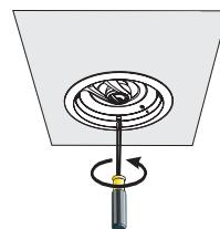
**10-** Isolieren Sie die Drahtenden um ca. 5 mm ab und bringen Sie jeden Draht in seine vorschriftsmäßige Anschlussposition. Ziehen Sie die Drahtsicherungsschrauben wieder fest an.
