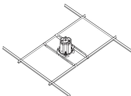
**16-** S'assurer que tous les tests et réglages sont terminés avant d'installer la grille. Localiser la grille du haut-parleur. L'armoire et la grille ont toutes deux une petite boucle formée par un cordon en plastique. En utilisant le clip sur le cordon de la grille, attacher la boucle de sécurité de la grille à celle de l'armoire. Insérer avec précaution la grille dans sa fente de retenue et appuyer fermement en position. Procéder lentement et uniformément pour éviter d'endommager la grille.
