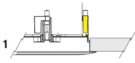
Ziehen Sie die Schraube jeder Klemme nach dem Einsetzen des Gehäuses in den Montageausschnitt mit einem Kreuzschlitzschraubenzieher (Nr. 2) an (siehe Abb. 2, rechts).
