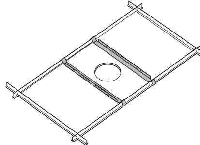
**3-** 将电线从安装孔中拉出。
