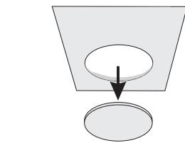
**5-** Pase el soporte de anillo en C a través del orificio. Primero deslice la ranura de la abertura en el orificio, y luego gire el soporte para que pase a través del orificio. Asegúrese de que los cables pasen a través del anillo.
