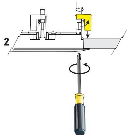
Une fois l'armoire installée dans la découpe, serrer chaque vis de bride avec un tournevis cruciforme no. 2 (voir 2 à droite).
