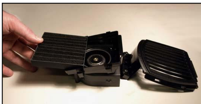
Рисунок 14: Выравнивание воздушного фильтра головной части
