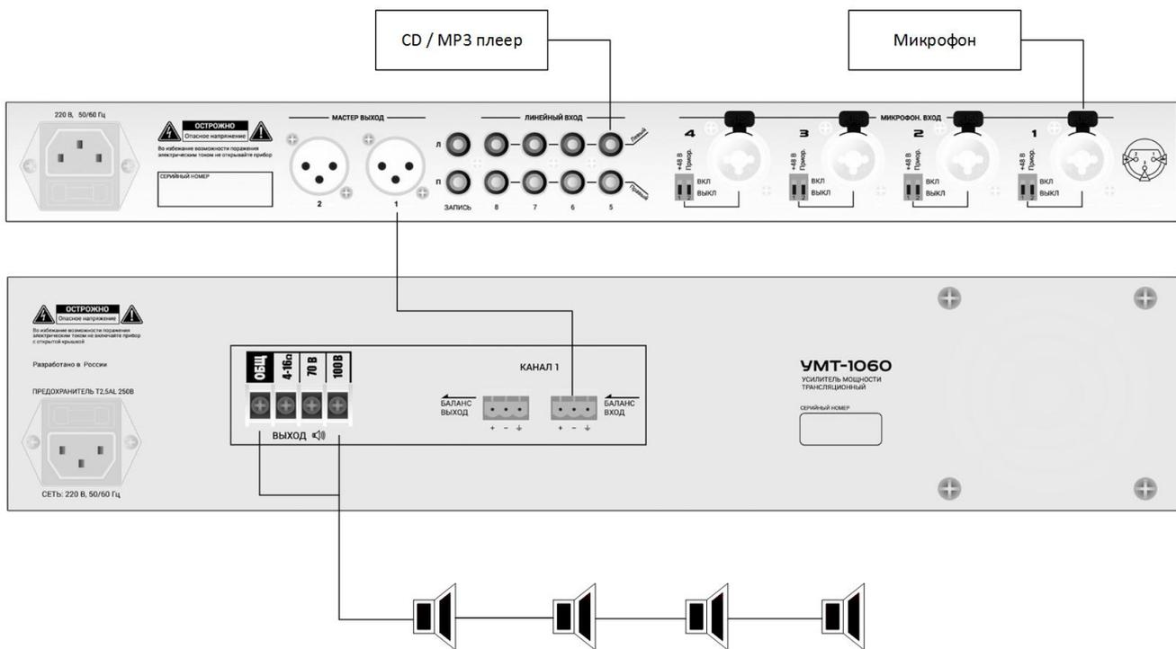
\* аналогичное подключение производится при работе в режиме 70в. (используйте соответствующую клемму).
