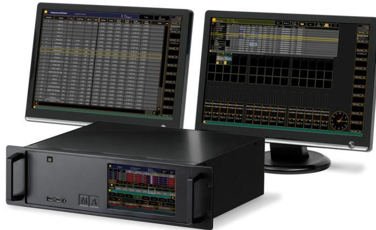
Neben den drei grandMA2 Pultmodellen (full-size, light, ultra-light) ist ebenfalls eine grandMA2 replay unit erhältlich. Dank ihres 19 Zoll Gehäuses lässt sie sich perfekt in Racks einbauen. Darüber hinaus bietet die grandMA2 replay unit dieselben Funktionen und Features des grandMA2 Systems.
