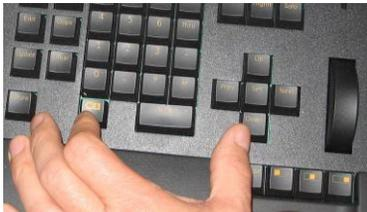
Durch intensiven Betrieb des Schwenkantriebes kann es vorkommen, dass der Motor durch die Temperaturüberwachung kurzzeitig ausgeschaltet wird. In dieser Zeitspanne den Monitor-Wing mit der Hand verstellen: **MA** und **Set** – Tasten halten und den Wing in die gewünschte Position schwenken. Nach Lösen der Tasten bleibt diese Position fixiert.
