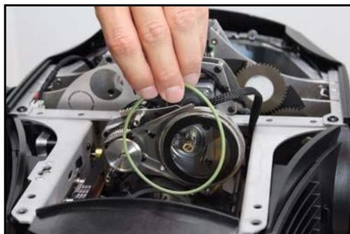
Рисунок 18: Снятие приводного ремня призмы
