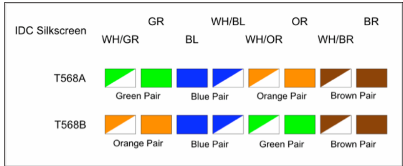
IDC wiring scheme
